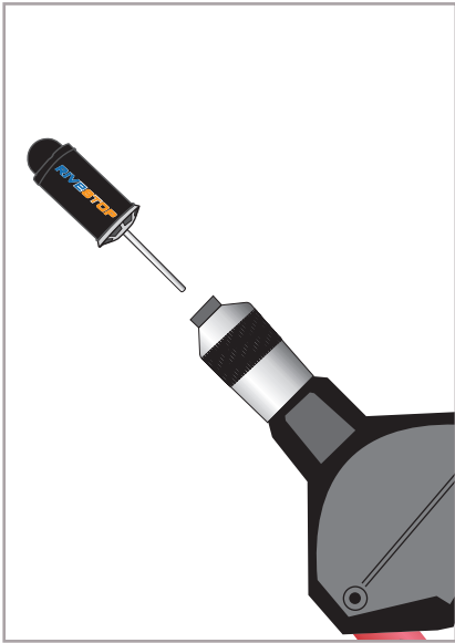
O modo de uso é tão simples como inserir, embocar e accionar a máquina de rebitar
